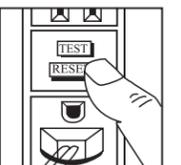
(d) Presione el botón TEST (y después el botón RESET) cada mes para asegurar un funcionamiento correcto. Si el GFCI no se puede restablecer, debe reemplazarse.
